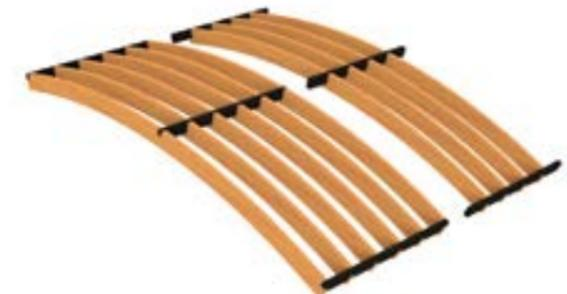
Schritt 3: Montagefertiges Paneel, abgesehen vom Bohren der Konterlatten für die Aufhängungen (Ø 9 mm)
